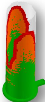
Image: Prédiction de défaut de coulée dans ProCAST (Crédit Photo : Swerea)
