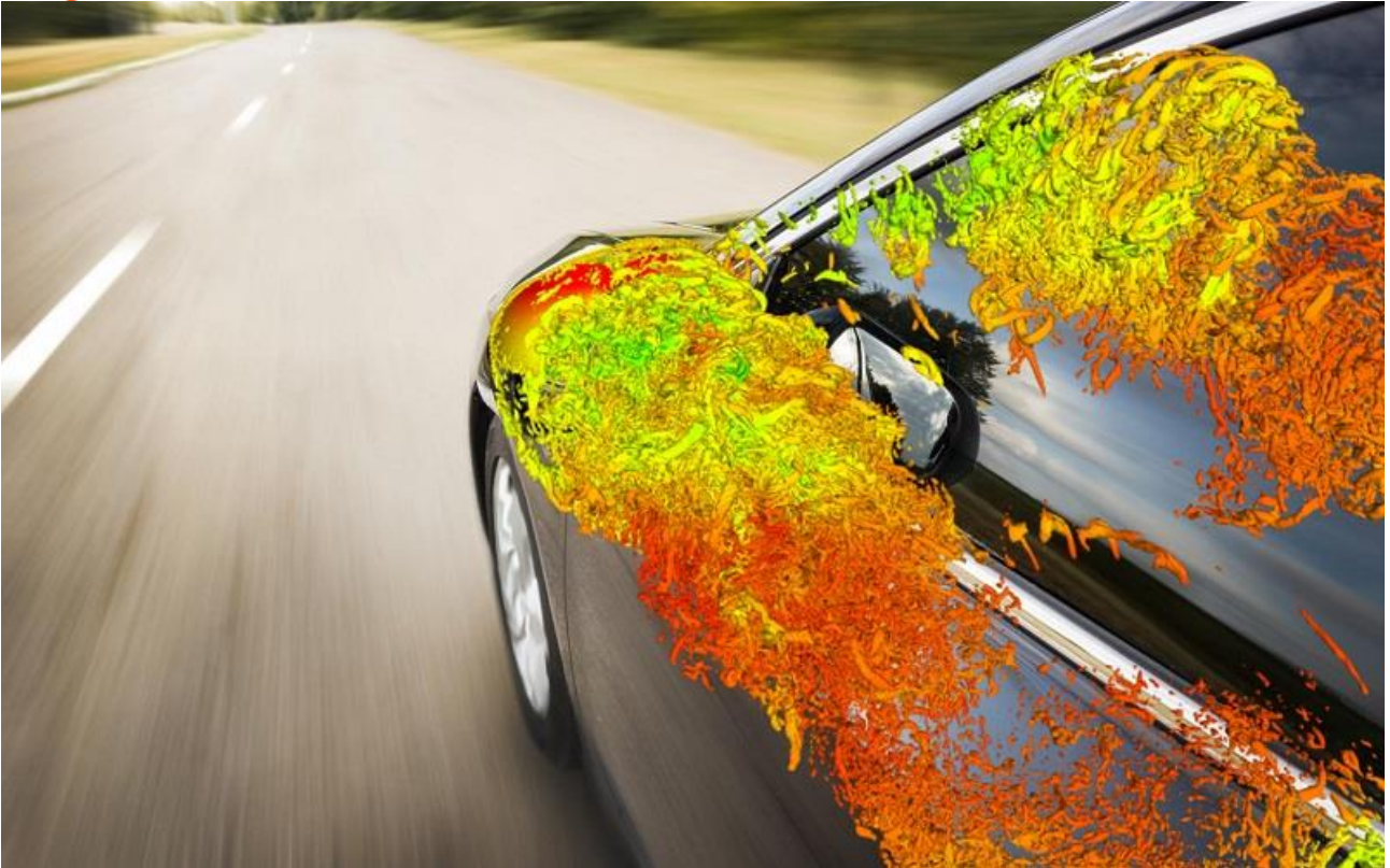
Image: Pressions de surface fluctuantes sur la vitre d'un véhicule, calculées en utilisant le code CFD open source OpenFOAM® . Des données de pression de surface fluctuantes ou complexes peuvent être importées dans ESI VA One à partir de n'importe quel code de CFD.
