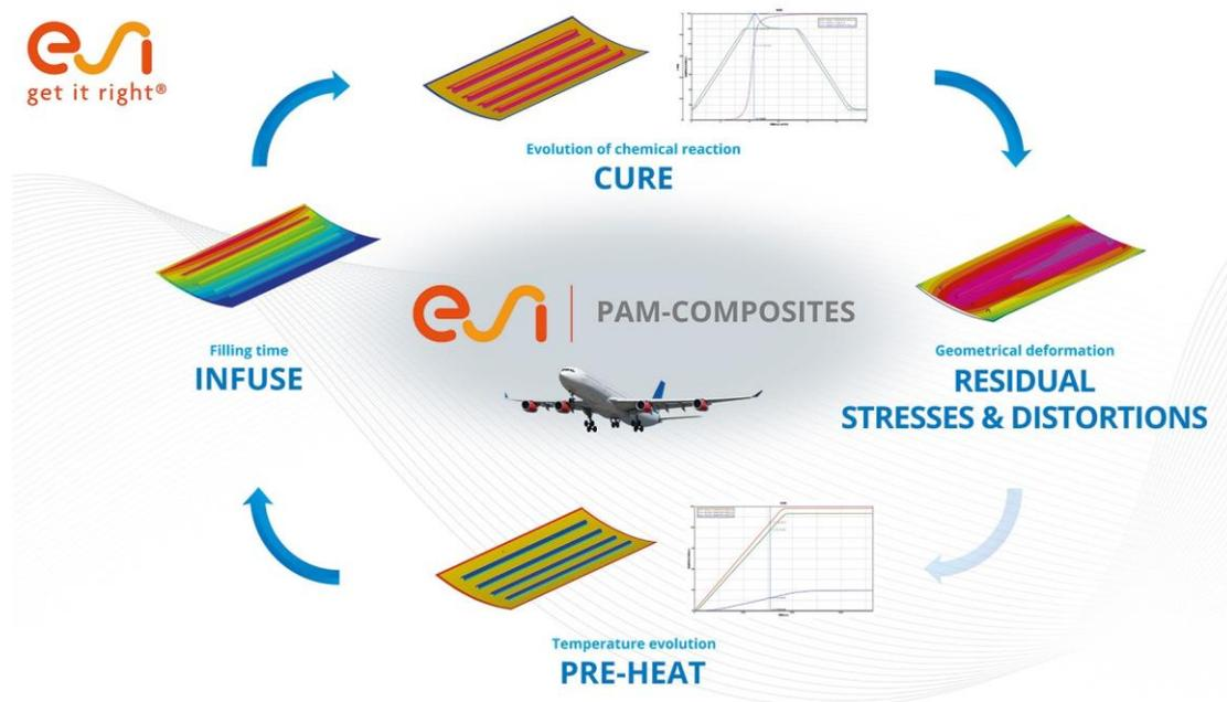
Image: Exemple d'application: ESI PAM-COMPOSITES permet de prédire l'ensemble de la chaîne de fabrication pour l'élaboration d'un panneau de fuselage aéronautique en composite zéro défaut.
