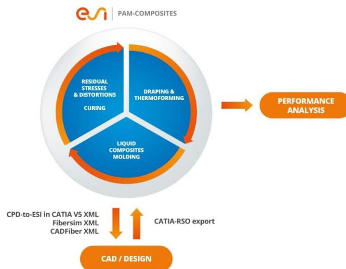
Image: ESI PAM-COMPOSITES permet la prédiction, l'analyse et la correction des défauts de fabrication des composants structuraux en composites à travers la chaîne de fabrication complète. Les procédés de fabrication couverts comprennent le drapage, le thermoformage, le moulage par injection et infusion de résine (LCM), le moulage par transfert de résine (RTM), et la cuisson.
