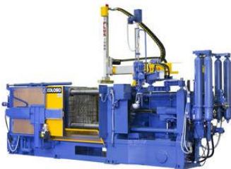
Image: Machine Colosio entièrement numérique - pour la coulée sous pression d'aluminium, du laiton, du zinc et des alliages de magnésium.
