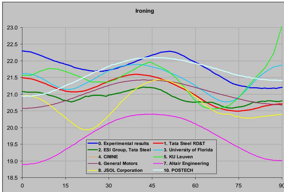
Image: Résultats de l'étude comparative de laminage lors de NUMISHEET 2011, comparant les résultats expérimentaux (en bleu foncé) aux 10 résultats de simulation. Les résultats fournis par PAM-STAMP 2G d'ESI (en vert foncé) ont été jugés les meilleurs car les plus proches de la réalité.
